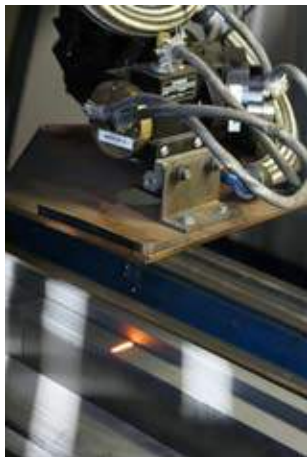
Laserhärten bis 100mm Breit / Laser-hardening till 100mm widet
