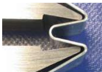
Fertigung: 5 Stück Kartenhalter pro Hub / 5 pieces mapholder per stroke
