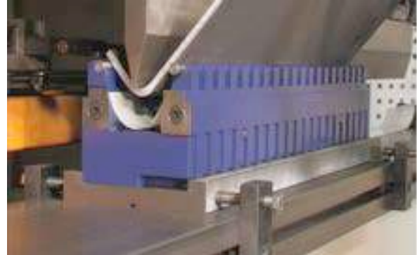
Große Öffnungsweite: z.B. bis 300 mm / large opening width: for example till 300mm
