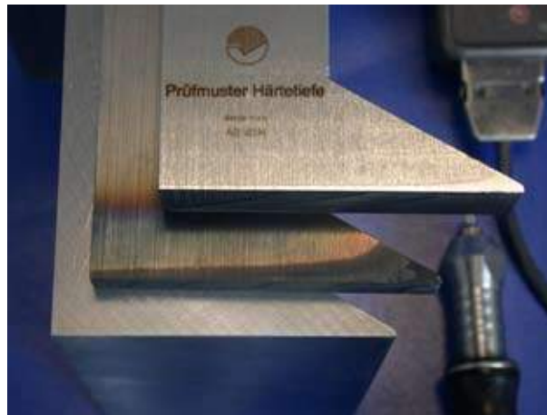
vorher, nachher, Trennschnitt / Einhärtetiefe / before, after, complete separation cut / hardening depth
