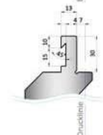
70.600 Modifikation : hydraulische Klemmung Gasparini
