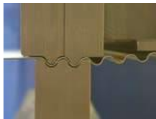
Prägen des nachfolgenden Wellenprofils / embossing of the following profil
