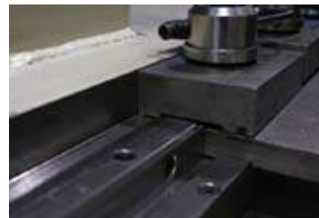
nachgeschliffene Spannelemente / regrounded clamping elements
