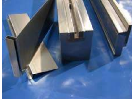
Werkzeug mit durchgehärteten (HRC60) und polierten Einsätzen / tools with sufficiently hardness (HRC60) and polished issues
