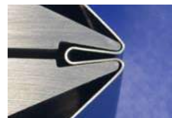
Zudrücken des geschlossenen Profil / pressing the closed profile
