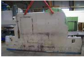
ausgebaute Oberwange / assembled upper beam
