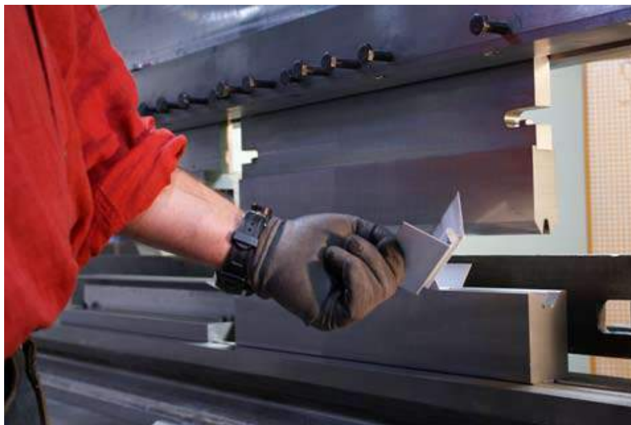
Fertigung: 5 Stück Kartenhalter pro Hub / 5 pieces mapholder per stroke
