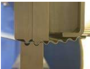
Einlegen der vorherigen Kantung / inserting of the previous bending
