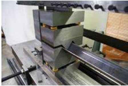
Frei tragender Niederhalter / cantilever blankholder
