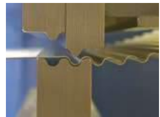
Prägen des nachfolgenden Wellenprofils / embossing of the following profil
